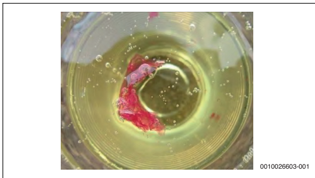
Рис. 68 Масло, содержащее примеси, которые могут засорить фильтр
