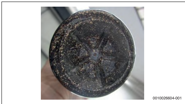
Рис. 69 Масло, содержащее частицы меди
