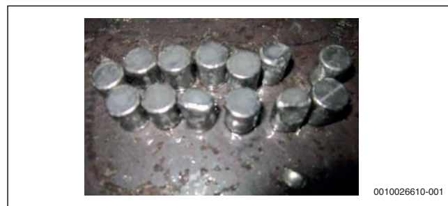
Рис. 75 Seriously изношенные и поврежденные подшипники
